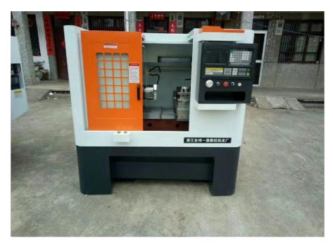
驱动装置是线轨数控机床执行机构的驱动部分,包括主轴驱动单元、进给单元、主轴电机和进给电机。他通过电液伺服系统在数控装置的控制下实现主轴和进给驱动。当多个进给联动时,可完成定位、直线、平面曲
