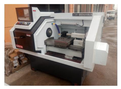
线轨机床修模(二次上机床)应找好基准位,然后XY水平方向校表,应避免忘了校表导致严重错位造成报废。工件加工时:机床工作前,开机热身10分钟方可下刀。工件加工时应重新检查程序下刀点,刀具大小是否与程序单符号统一[]Z.J.K[][做到加工规迹心中有数。特别是刀具千万不可拿错,造成报废。如有异立即与编程者一同检讨,操机者不得随意加工,否则后果自负。工件加工时应有意识试刀,特别是大工件(程序单须写明尺寸)一刀走完要用卡尺检验座标是否中心,造成错位报废。江西高速线轨机床品牌线轨机床前置时间短,轨道的一般前置时间半个月内就可以完成。
